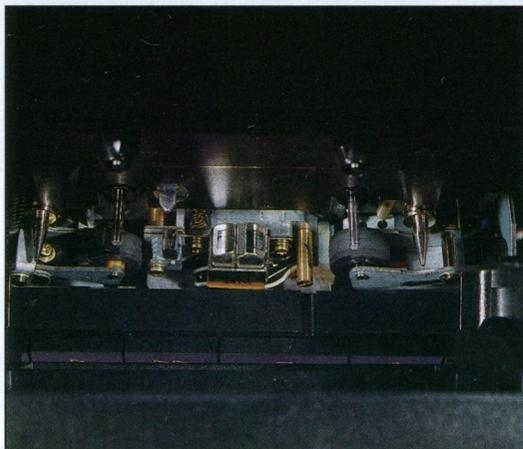
Il sistema a tre testine dell'Harman Kardon CD 491 si avvale di una testina sendust per la registrazione e di una in ferrite per la riproduzione. In tal modo è possibile ridurre la distorsione coll'aumentare della risposta alle alte frequenze e della gamma dinamica. Il CD 491 è dotato anche di doppio capstan «closed loop».
